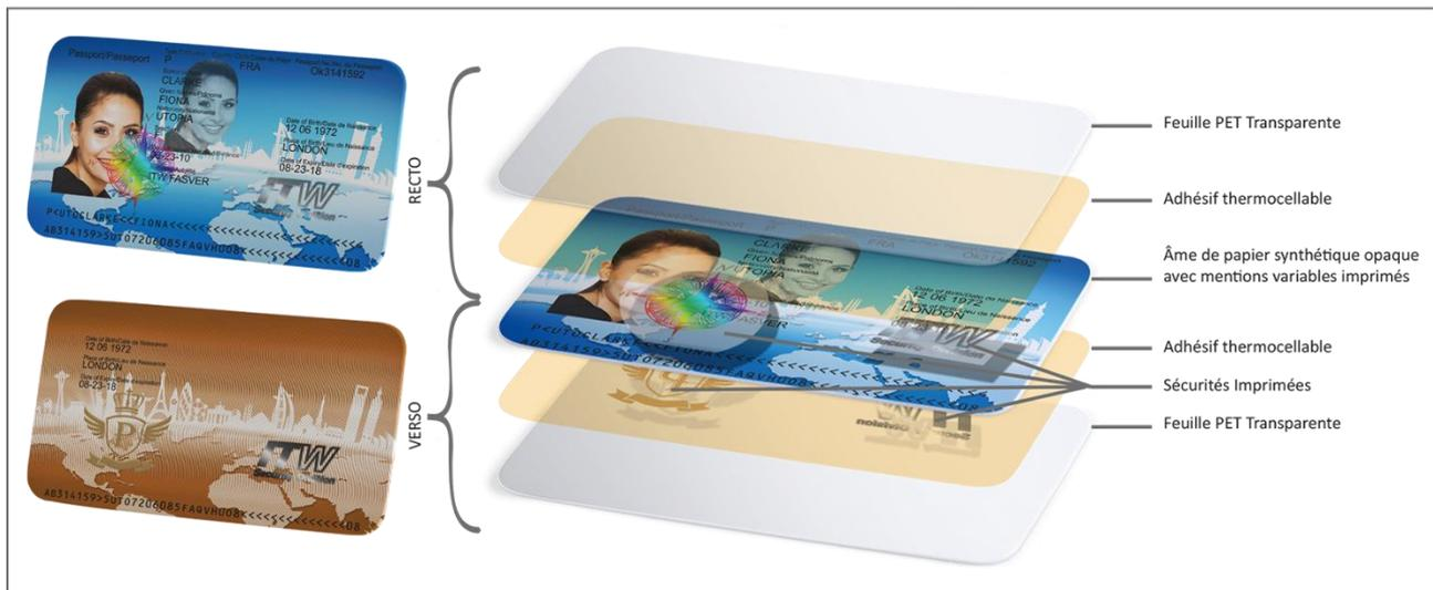
Diagramme 9: Une structure typique de Teslin® / Synthetic Paper
