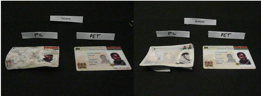
Diagramme 10: L'impact des produits chimiques sur les substrats des cartes PC et PET.
